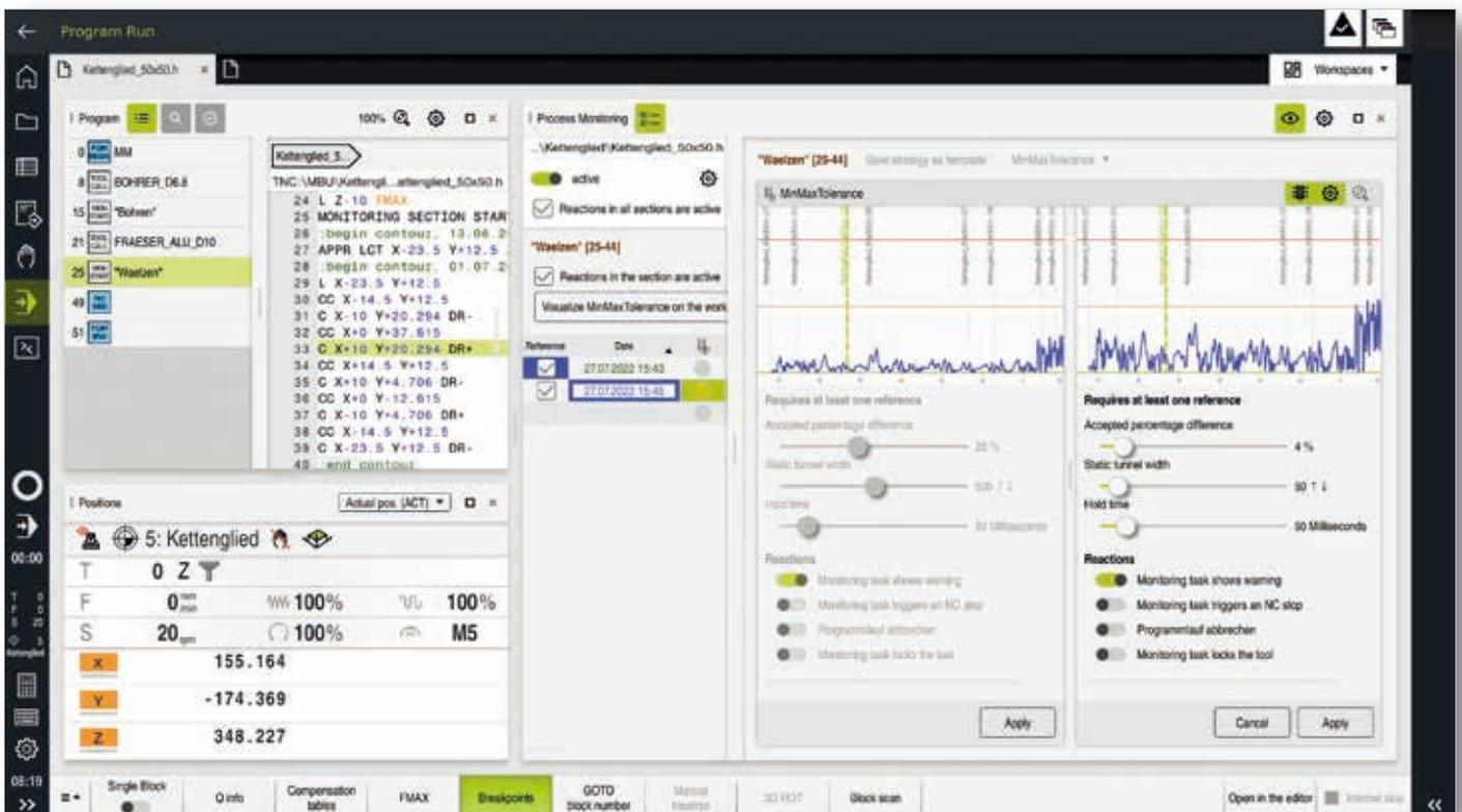
TNC7的部件监测功能有效保护高价值的机床投资。机床制造商用这些工具可执行大量监测。在加工期间，监测功能可保护主轴轴承，避免过载，检测传动系部件的磨损加剧等情况。
